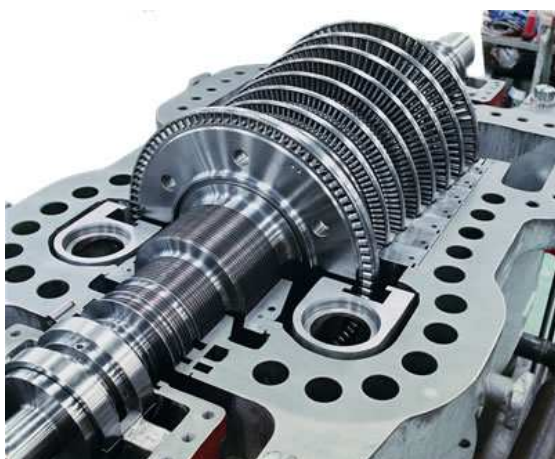
Figura 1.8 Detalhe interno de uma turbina a vapor de múltiplo estágio de ação.
