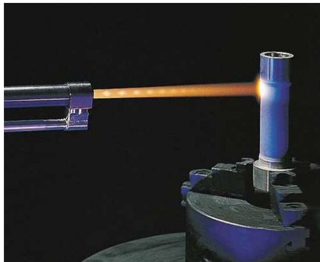
Figura 2.8 Exemplo de uma aplicação por aspersão térmica [30].
