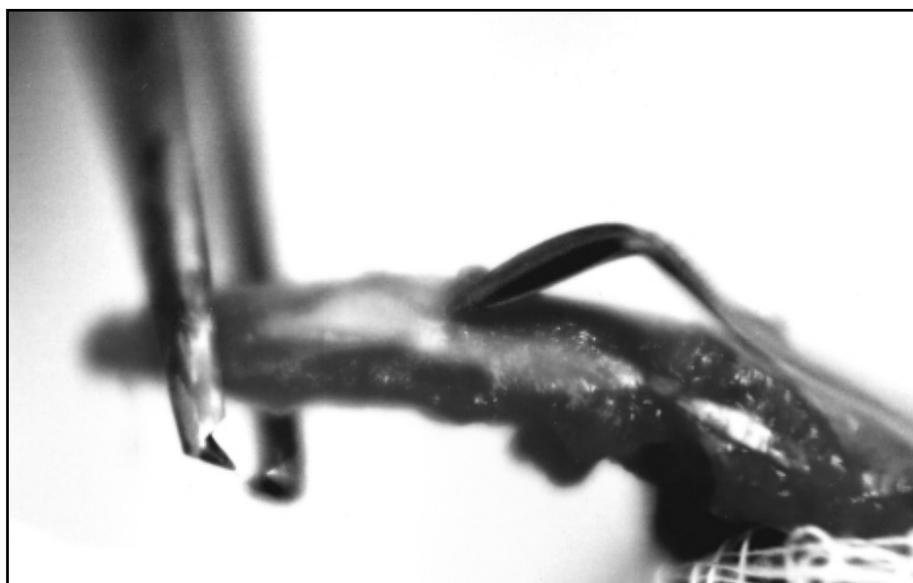
Figura 4.8 (a): Implante do compósito na tíbia do animal após 35 dias. Corpo de prova do compósito em posição.
