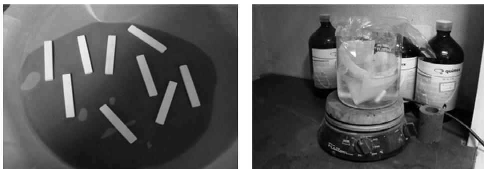
Figura 3.7 (a)e(b):Ensaio de resistência à corrosão.
