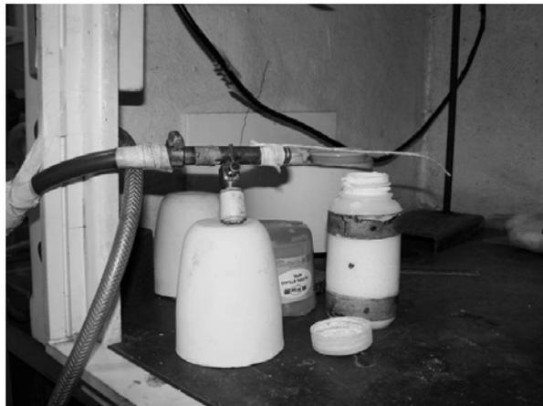
Figura 3.4: Detalhe da secagem mostrando o fluxo de ar perpendicular à entrada do frasco de secagem.
