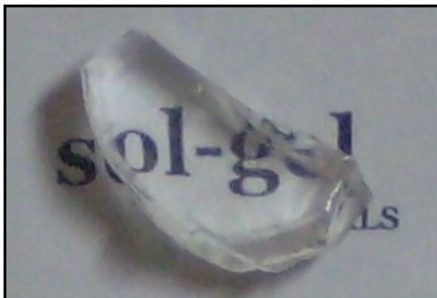
Figura 5.1: Ilustração do gel Bio1\_TEP sintetizado com a utilização do TEP como precursor de fósforo.
