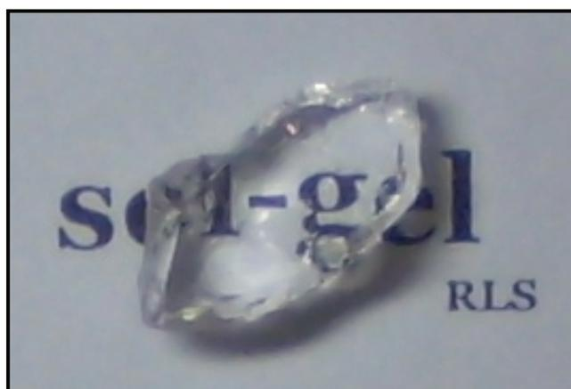
Figura 5.6: Ilustração do gel Bio2\_AFos sintetizado com a utilização do H<sub>3</sub>PO<sub>4</sub> como precursor de fósforo.
