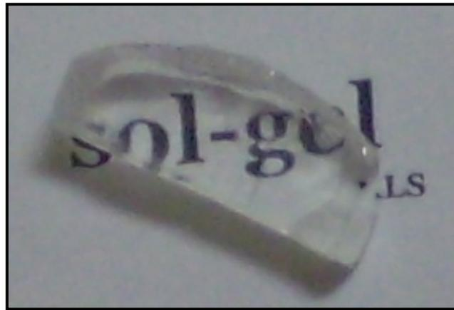
Figura 5.22: Ilustração do gel Bio5\_TEP-Na sintetizado com a utilização do TEP como precursor de fósforo.
