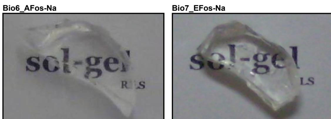
Figura 5.25: Ilustração dos géis Bio6\_AFos-Na e Bio7\_EFos-Na sintetizados com a utilização do  $H_3PO_4$  e do precursor de fósforo previamente elaborado a partir da dissolução do  $P_2O_5$  em etanol (refluxo 24h), respectivamente.
