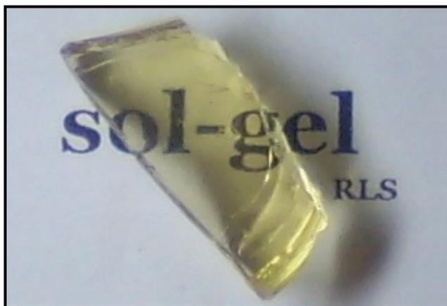
Figura 5.12: Ilustração do gel Bio4\_AFit sintetizado com a utilização do ácido fítico como precursor de fósforo.
