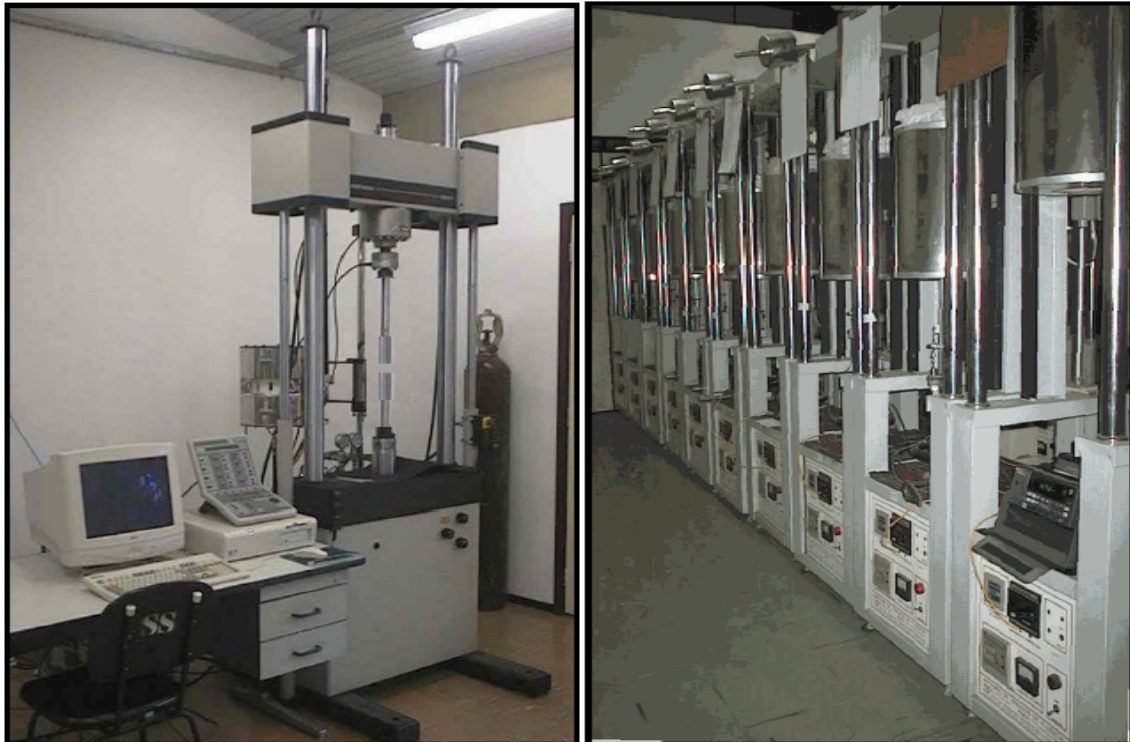
Figura 3.4 a) Máquina de ensaios de tração servo-hidráulica INSTRON, modelo 8802; b) Conjunto de máquinas de ensaios de fluência usadas no presente trabalho.
