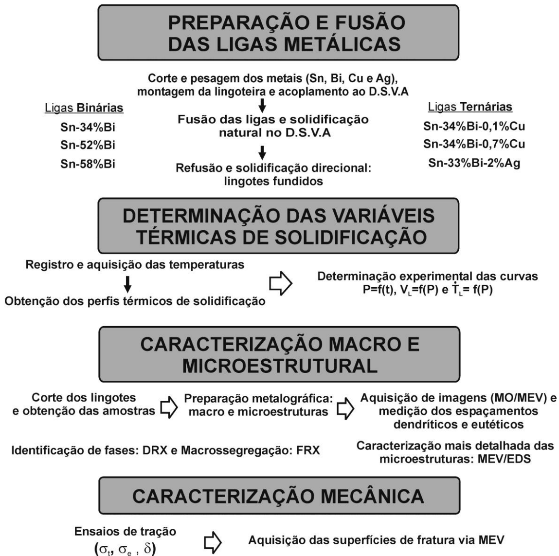
Figura 21 Fluxograma geral das etapas experimentais envolvendo solidificação de ligas Sn-Bi e Sn-Bi-X. D.S.V.A. significa dispositivo de solidificação vertical ascendente.
