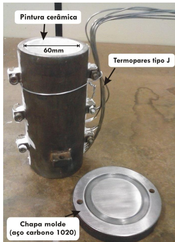
Figura 23 Lingoteira de aço inoxidável AISI 310 e a chapa molde de aço carbono 1020.
