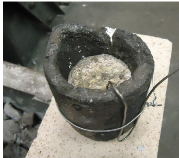
Figura 25 Cadinho de carbeto de silício, metal fundido e termopar utilizados para determinação das temperaturas liquidus , solidus e eutética das ligas binárias Sn-Bi, e ternárias Sn-Bi-Cu e Sn-Bi-Ag.
