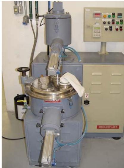
**Figura 3.1** – Misturador intensivo com resfriador vertical MECANOPLAST modelo ML-9, do laboratório da Braskem S.A.
