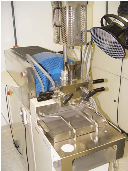
**Figura 3.2** – Reômetro de Torque Haake-Rheomix 600p, do laboratório da Braskem S.A.
