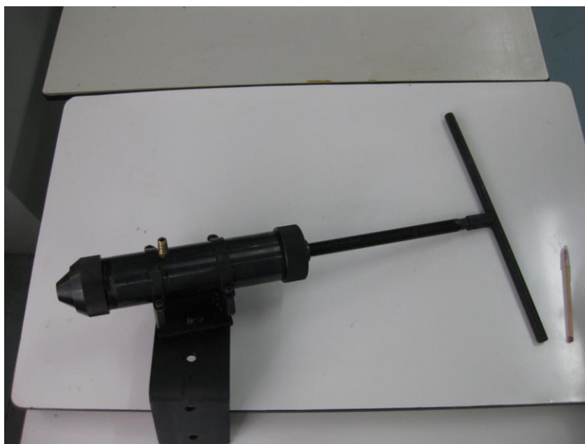
Figura 3.1 Foto da extrusora manual tipo pistão construída especificamente para conformação dos corpos de prova para ensaio de flexão por 3 pontos.
