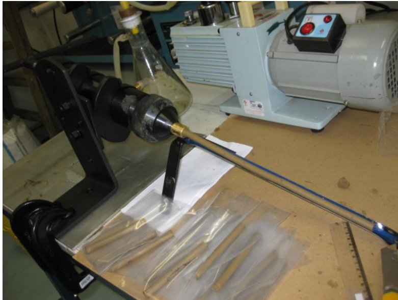
Figura 4.6 Foto do sistema de conformação de corpos de prova com seção transversal circular para realização do ensaio mecânico de flexão por 3 pontos.
