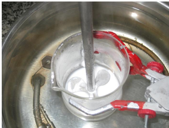
Figura 4.1 Foto do sistema de polimerização da ureia-formaldeído na proporção 1:1.
