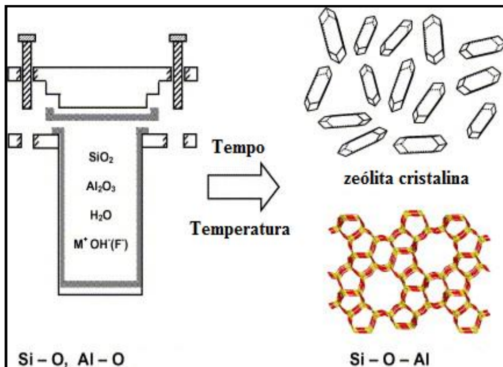
Figura 2.5 – Esquema da síntese hidrotérmica de zeólitas.
