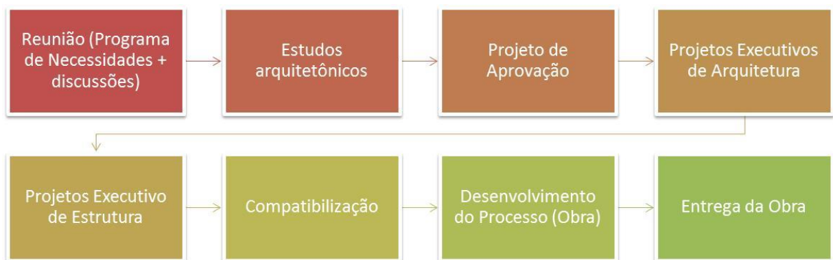
Figura 41 - Principais serviços e atividades do processo de projeto para desenvolvimento do produto
