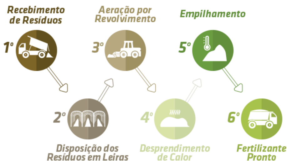
Figura 1: Processo de produção do Fertilizante Classe D através da compostagem do lodo de esgoto. Fonte: Tera Ambiental, 2015.
