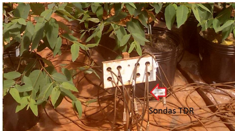
Figura 5: Sondas de TDR utilizadas para o monitoramento da umidade e condutividade elétrica do solo.
