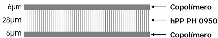
FIGURA 3.1 Esquema da distribuição nominal de espessuras das películas que serão utilizadas nesse estudo – espessura total 40µm.
