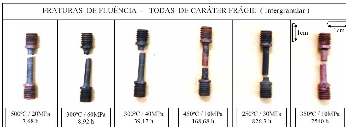
Figura 4.32 Corpos de prova fraturados por fluência organizados em ordem crescente do tempo de ruptura.
