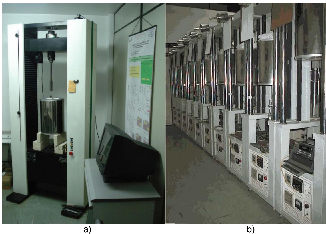
Figura 3.5 Equipamentos usados neste trabalho: a) Máquina universal de tração (TIME WDW-100E); b) Conjunto de 10 máquinas de fluência (STM MF-1000).
