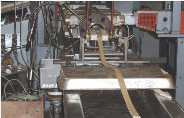
Linha de extrusão utilizada no processamento das blendas
