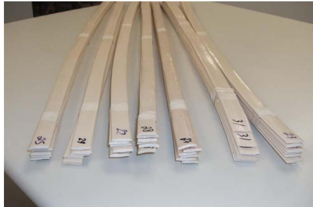
Blendas PBT/ABS obtidas na forma de fitas
