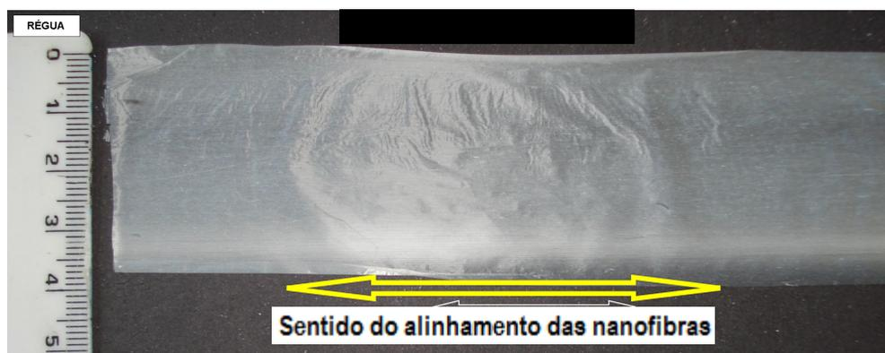
Figura 4.6 - Foto de uma manta de nanofibras produzida a velocidade de 4000 rpm. A seta em amarelo indica o sentido do alinhamento e a régua está em centímetro.
