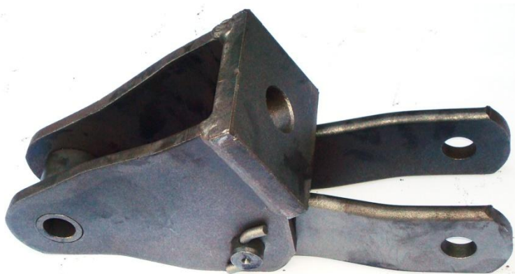
Figura 1.1 - Elos de correntes industriais utilizados nos equipamentos das esteiras intermediárias nas moendas das usinas de cana-de-açúcar.
