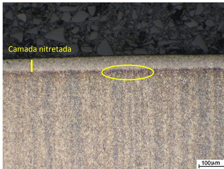
Figura 4.10 - Aspecto da camada nitretada do aço AISI-420C obtida na temperatura de 450°C. Tratamento de nitretação realizado em 5 horas com pressão de 5 mbar e mistura gasosa com 20% de N 2 .
