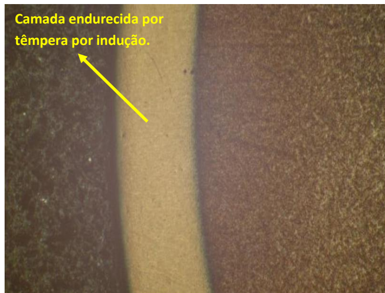
Figura 4.3 - Micrografia do aço AISI-4140 temperado por indução realizadas com aumento nominal de 12x.
