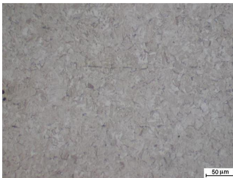
Figura 4.4 - Microestrutura típica do aço DIN16MnCr5 cementado, temperado e revenido.
