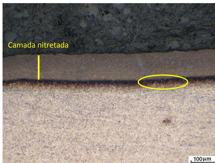
Figura 4.11 - Aspecto da camada nitretada do aço AISI-420C obtida na temperatura de 500°C. Tratamento de nitretação realizado em 5 horas com pressão de 5 mbar e mistura gasosa com 20% de N 2 .
