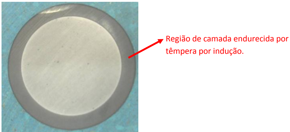
Figura 4.2 - Camada formada pelo processo de têmpera por indução.
