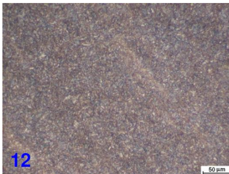
Figura 4.1 - Aço inoxidável martensítico AISI-420C temperado. Microestrutura martensítica.
