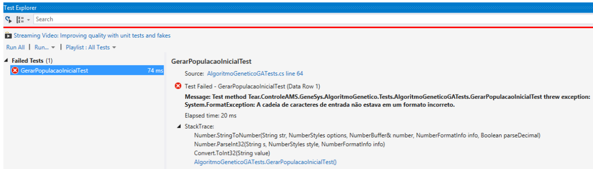
Figura 6-2 - Parte da tela referente à execução do teste com entradas incorretas para avaliação do método GerarPopulacaoInicial
