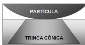
Figura 2.15: Esquema ilustrativo de uma trinca de Hertzian [52].
