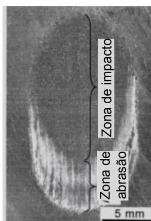
Figura 2.8: Superfície desgastada, com duas diferentes zonas de desgaste [37].
