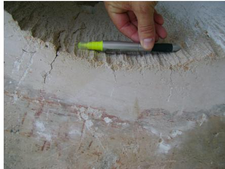
Figura 2.5: Revestimento refratário desgastado por erosão (foto fornecida pela Alcoa/Poços).
