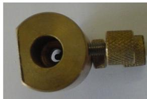
Figura 2: sistema de alimentação de partículas abrasivas.
