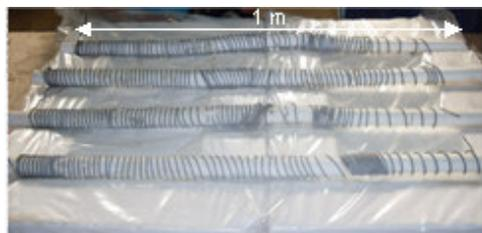
Figura 4.3: Resistências elétricas do forno superior queimadas.
