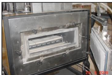
Figura 3.5: Porta amostras do erosímetro a quente.
