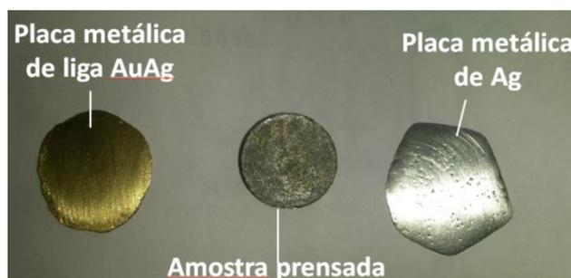
Figura 3.4 Imagem das placas metálicas de Ag e da liga  $AuAg_{8,8\%p}$  e de uma amostra prensada, utilizadas para a confecção das pilhas, cuja FEM foram medidas com um milivoltímetro.
