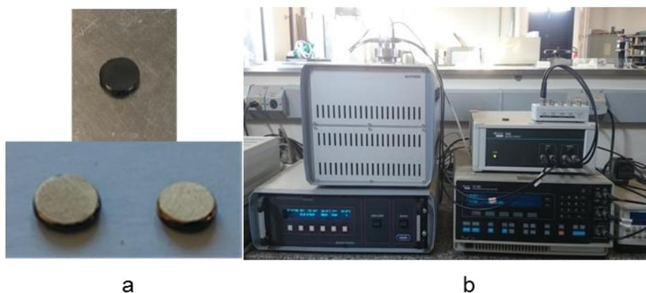
Figura 3.3 a) Amostras antes e depois de recobrimento com ouro e b) equipamentos utilizados neste projeto mostrando o impedâncimetro (à direita) e o forno (à esquerda) contendo o porta-amostra.
