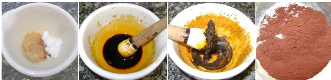
Figura 4.18 Síntese do nano- $\text{Fe}_2\text{O}_3$ : da esquerda para a direita mostra-se o início da reação entre o nitrato de ferro e o bicarbonato de amônio, o líquido avermelhado produzido por essa reação, a massa argilosa obtida com a sua secagem e, por último, o nano-pó já pronto.
