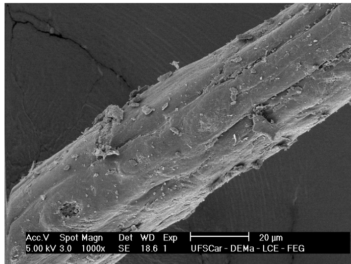
Figura 5.6 Fotomicrografia de MEV da fibra de acuri (1000x).
