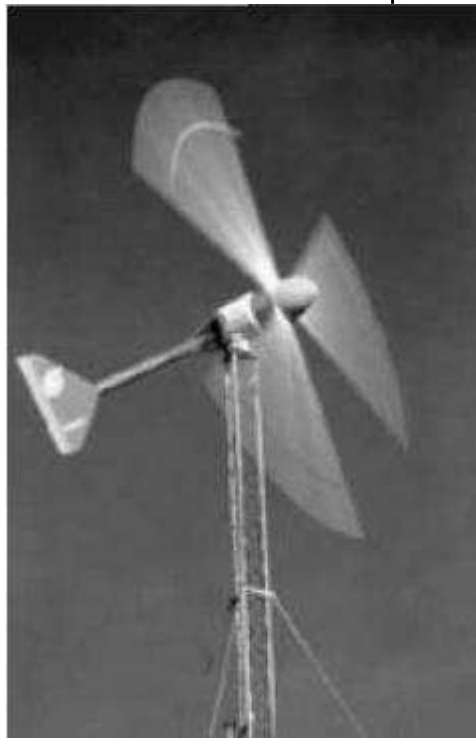
Figura 2 - Turbina Eólica de Pequeno Porte
