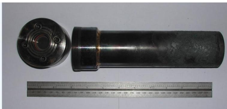
Figura 3.6 Tubo utilizado na fabricação da pré-liga pelo segundo processo.
