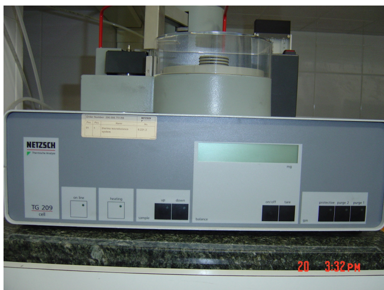
Figura 4.2: Equipamento experimental utilizado para os testes termogravimétricos.
