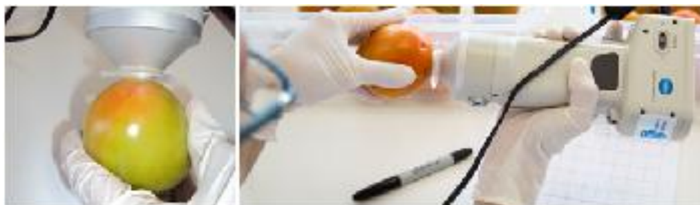
Figura 16. Determinação da coloração da superfície dos tomates tratados com os diferentes revestimentos
