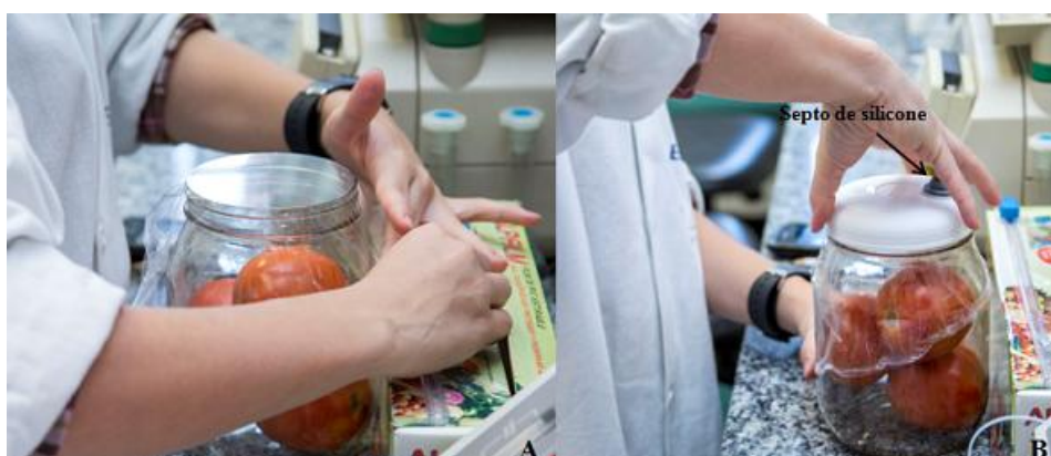
Figura 18. A) vedação dos frascos com filme PVC e B) fechamento dos frascos com tampa contendo septo de silicone.
