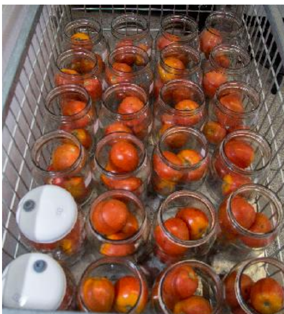
Figura 17. Tomates em recipientes de vidro para determinação da respiração e produção de etileno.
