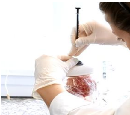
Figura 19. Coleta de alíquotas de 1,0 mL da atmosfera interna dos recipientes.
