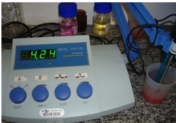
Figura 13. Determinação de pH pela mensuração direta das amostras compostas, trituradas e homogeneizadas.
