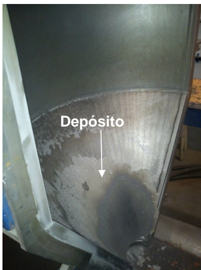
Figura 4.2 Partículas da liga \text{Fe}_{60}\text{Cr}_8\text{Nb}_8\text{B}_{24} aderidas à câmara de atomização, formando um depósito.
