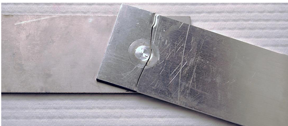
Figura 4.45 - Corpo de prova após ensaio de fadiga apresentando a falha através da seção transversal da chapa superior (ST)
