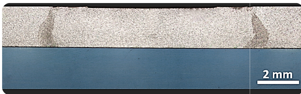
Figura 4.15 - Macrografia representativa da seção transversal da junta AA5754-H22/Ti6Al4V.
