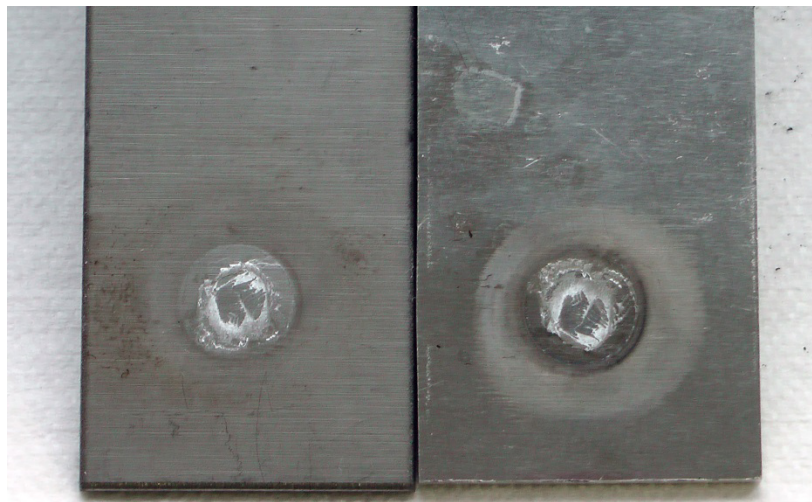
Figura 4.32 - Modo de falha interfacial apresentado por todas a juntas solicitadas por cisalhamento neste estudo.
