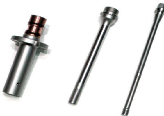
Figura 3.3 - Componentes da ferramenta de soldagem FSpW utilizada na produção das soldas.
