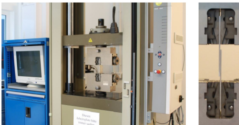
Figura 3.7 - Máquina modelo Zwick/Roell utilizada para a avaliação da resistência mecânica das juntas soldadas sob solicitação de cisalhamento.
