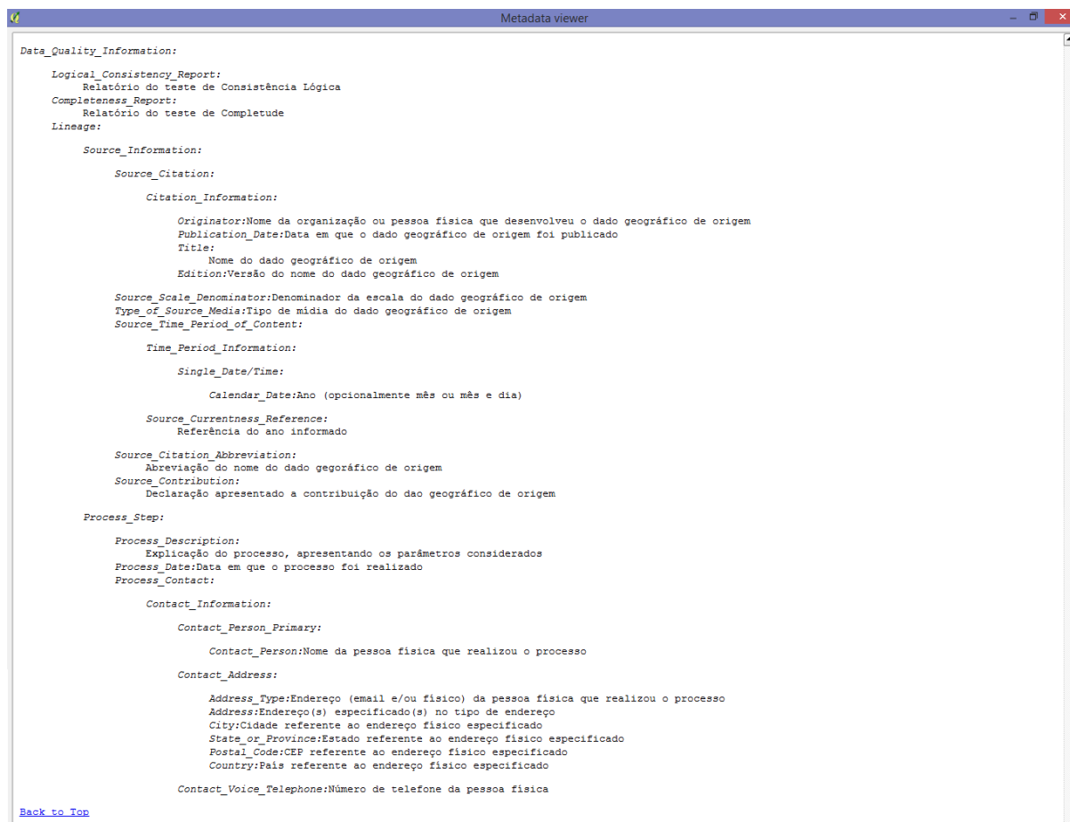
Figura 5.4 – Quantum GIS ( plugin Metatools) – Interface para visualização de metadados definidos segundo o padrão de metadados geográficos FGDC. Fonte: Adaptada de QGIS 2.14 (2016)
