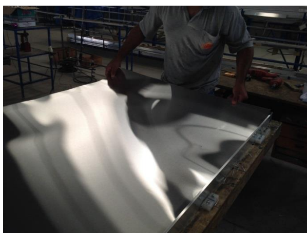
a) Montagem da caixa do coletor
