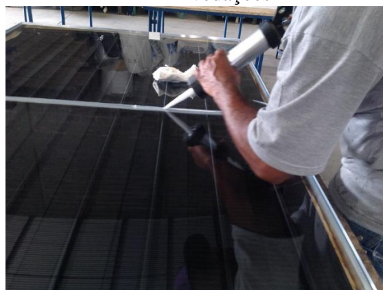
d) Montagem da cobertura de vidro do coletor
