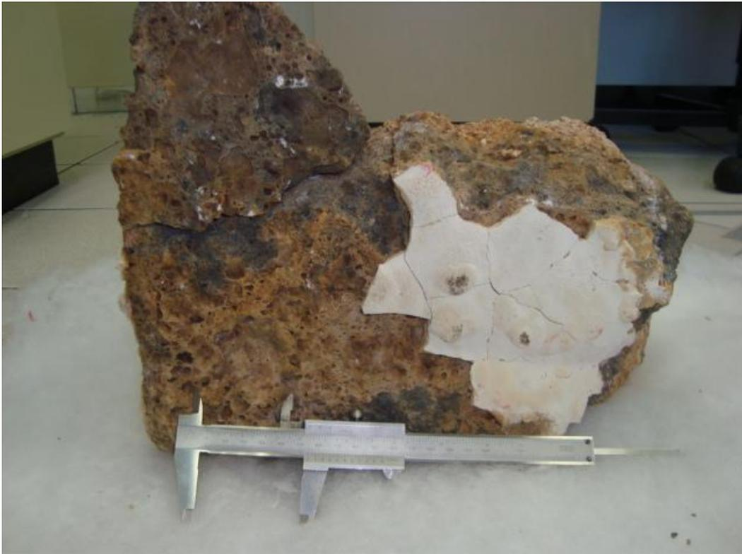
Figura 6.13 – Amostra retirada do Forno para análise *post-mortem*,
