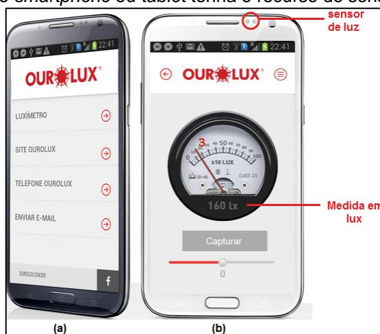
Figura 29 – Imagens de tela de execução do Aplicativo Ourolux : em (a) tem-se a tela inicial, e clicando-se na opção “luxímetro”, aparece a segunda tela (b), modo em que o dispositivo móvel passa a operar como medidor de intensidade luminosa, em lux. Detalhe: para o uso deste aplicativo é necessário que o smartphone ou tablet tenha o recurso de sensor de luz operante.
