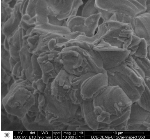
Figura 5.46. MEV das sílicas sintetizadas com diferentes teores de silônio: a = 0%, b = 5%, c = 10%, d = 20%, e = 0% silônio (mas com mesmo teor de MeOH que a sílica 6.c).
