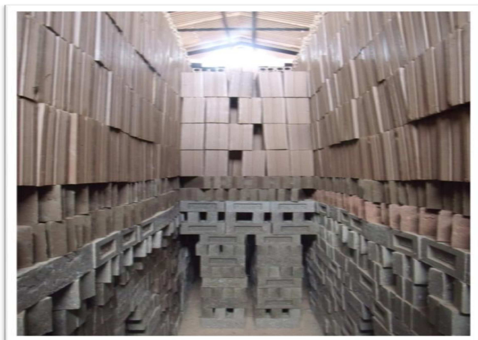
Figura 10: Empilhamento Manual dos Blocos Cerâmicos.
