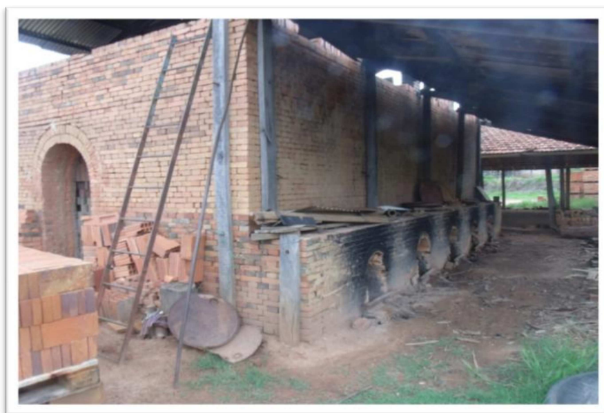
Figura 8: Vista Lateral do Forno de Chama Direta. Com Espaços para Alimentação por Lenha.
