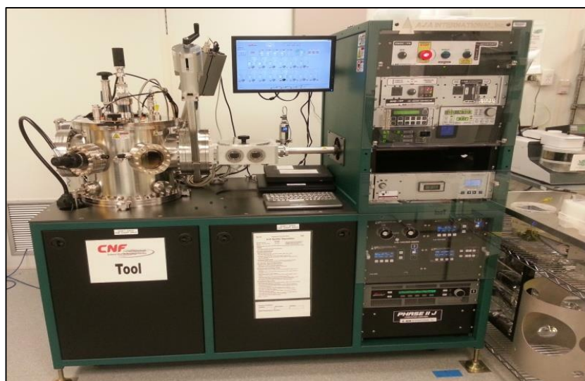
Figura 3.3.1.2 Sistema de Magnetron Sputtering instalado no CNPEM/LNNano.
