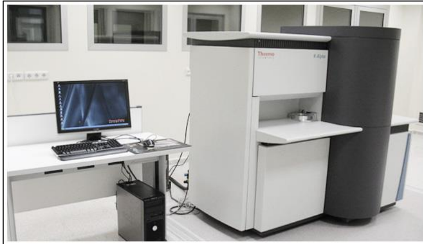
Figura 3.4.9.2 Espectrômetro K-Alpha (Thermo Scientific) instalado no LNNano.
