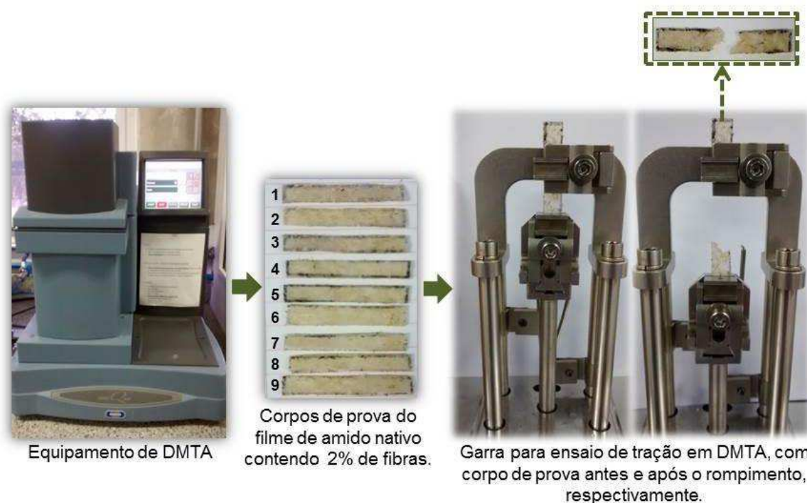
FIGURA 5 – Fotografias do ensaio de tração no equipamento de DMTA.
