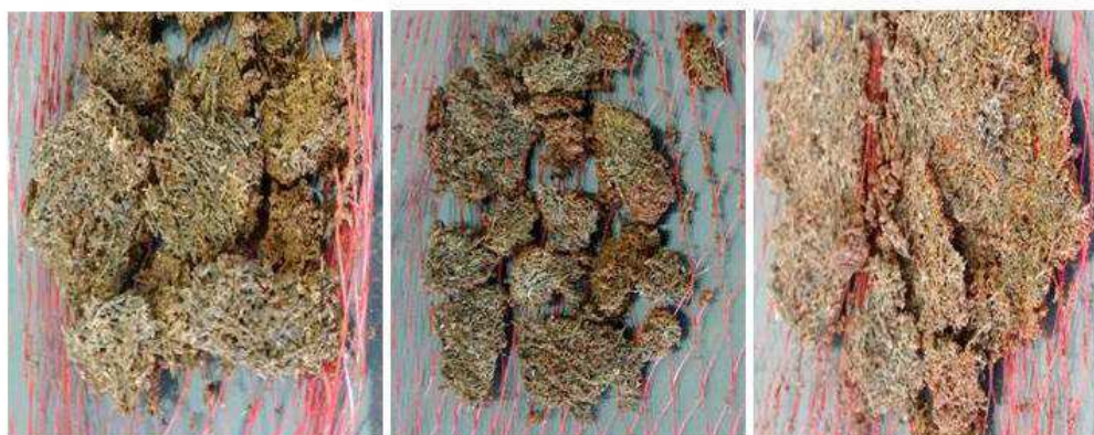
Amostras de amido contendo 3% de fibra de bagaço de cana (AF-3), após a retirada do solo.
