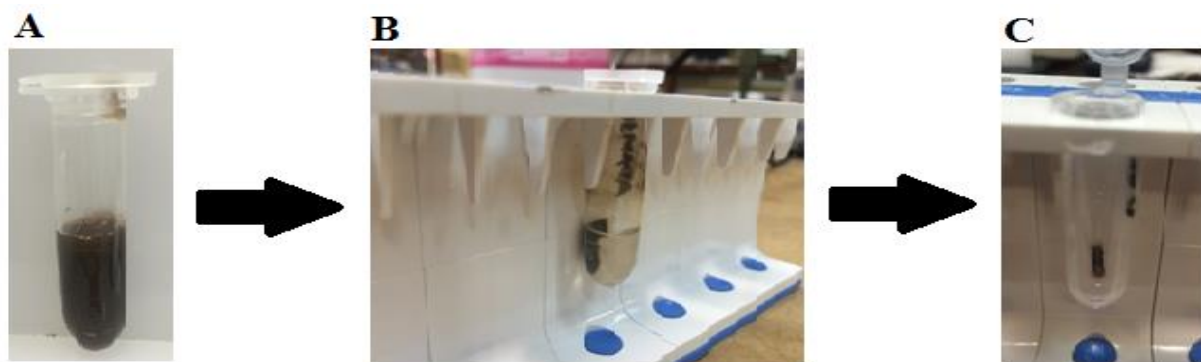
FIGURA 3. 3 - Procedimentos para a lavagem das PMs (A) PMs diluídas em tampão MES 0,05 \text{ mol L}^{-1} pH 5,2 (B) Separação magnética por meio de um suporte com imã (C) Retirada do sobrenadante.
