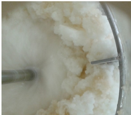
Figura 35 - Efeito caverna durante a hidrólise enzimática.
