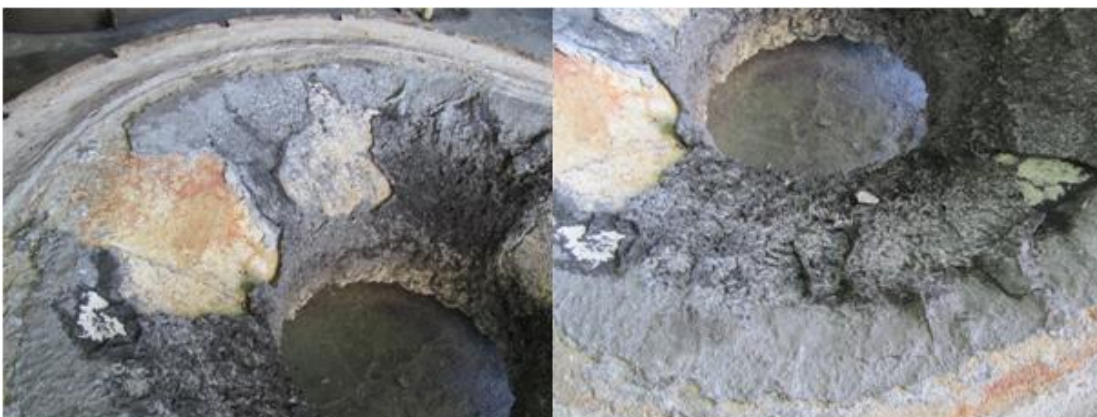
Figura 4. 14. Fotografias da tampa (2,0m de diâmetro) do cadinho com alumina e alumínio grudados após os transportes de alumínio líquido.
