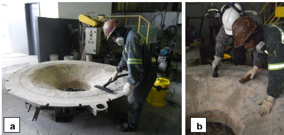
Figura 4. 15. (a) Tampa do cadinho sendo aspirada com um aspirador de pó, (b) sendo limpa com uma escova de cerdas de aço e logo em seguida sendo novamente aspirada.
