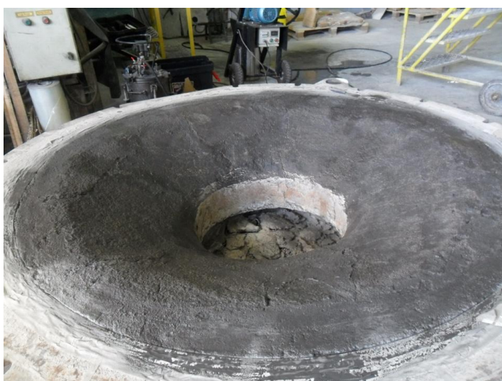
Figura 4. 18. Tampa do cadinho (2,0m de diâmetro) após a aplicação da tinta EM04.
