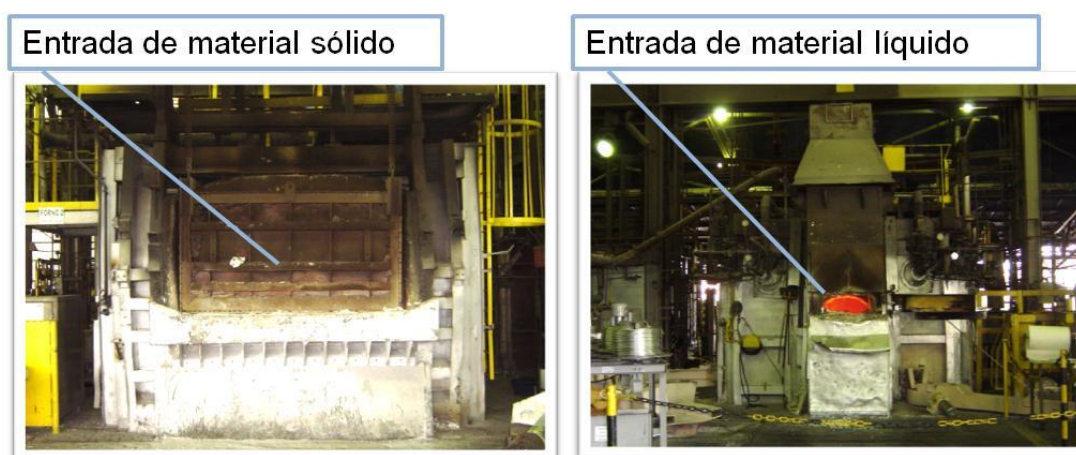
Figura 3. 3. Entradas para material sólido (esquerda) e líquido (direita) de um forno de fusão e espera [12]
