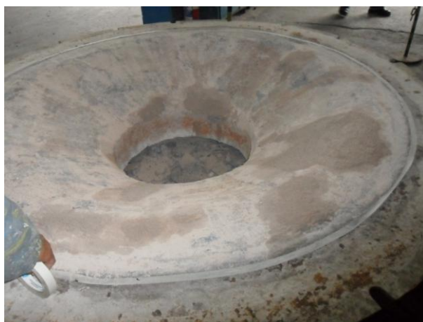
Figura 4. 16. Tampa do cadinho com fita crepe para separar a parte refratária da metálica e delimitar a região a ser pintada.
