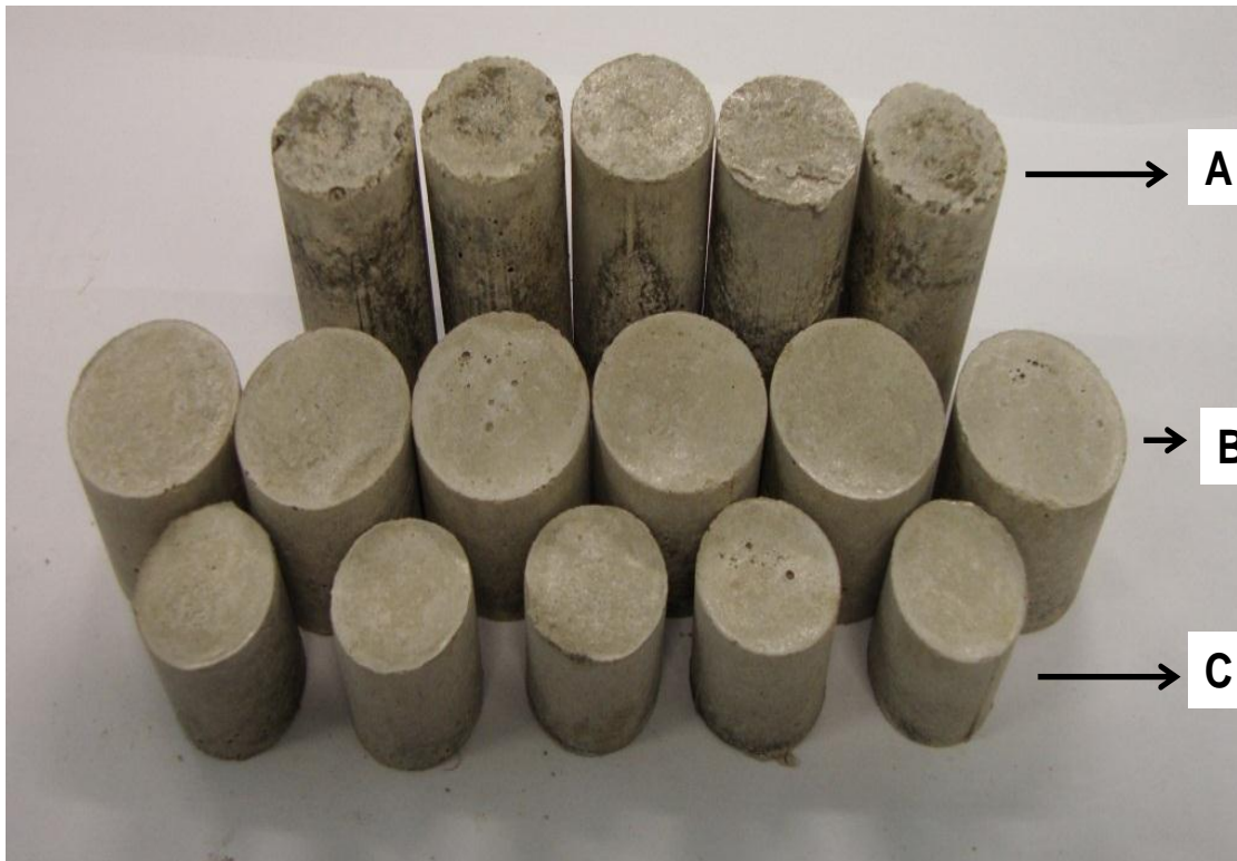
Figura 4.2: Corpos de prova utilizados para ensaios de: A) Resistência a compressão uniaxial; B) Ataque ácido; C) Porosidade aparente, lixiviação e porosimetria de mercúrio.
