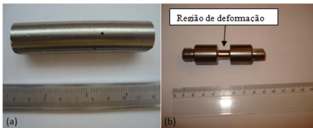
Figura 4.8: Corpo de prova na etapa intermediária do processo de usinagem (a), corpo de prova pronto para o ensaio de torção(b).
