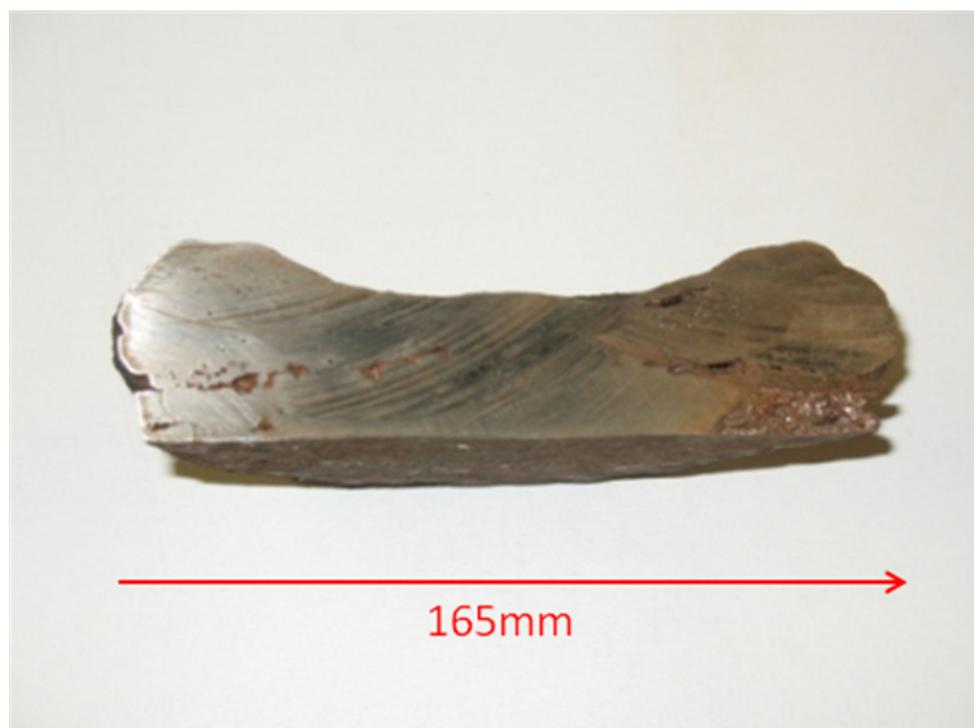
Figura 4.2: Imagem da seção transversal do Depósito 1, mostrando a elevada porosidade em toda a extensão.
