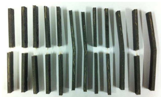
Figura 22 – Corpos de prova do ABS + 1 tecido de juta após o ensaio de flexão, dos quais 3 não fraturaram totalmente.
