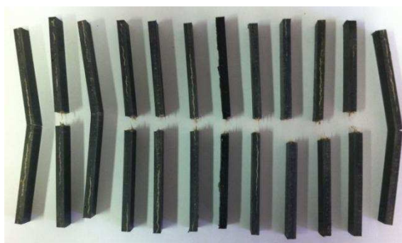
Figura 23– Corpos de prova do ABS + 2 tecidos de juta após o ensaio de flexão, dos quais 3 não fraturaram totalmente.
