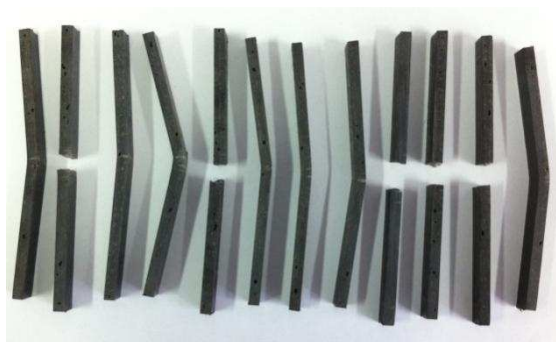
Figura 21 – Corpos de prova do ABS sem fibra após o ensaio de flexão, dos quais 7 não fraturaram totalmente.
