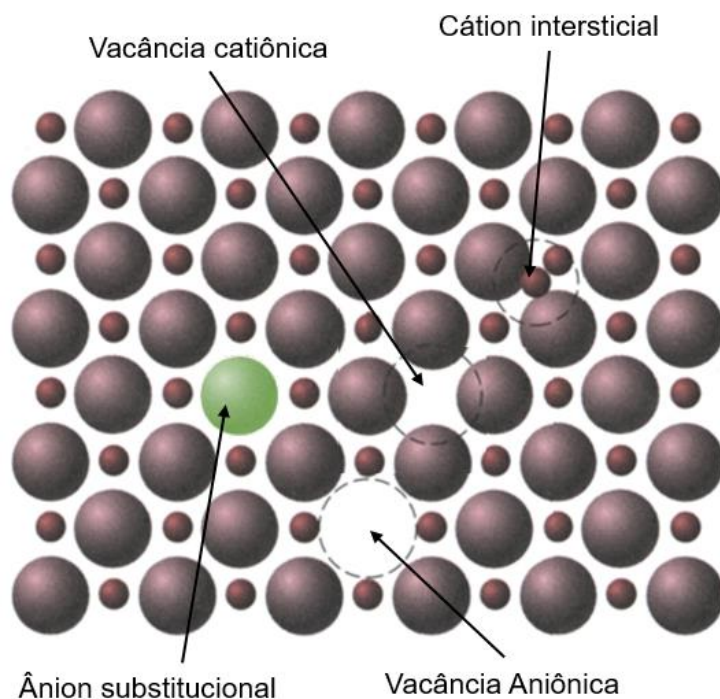
Figura 2.5 Representações esquemáticas de defeitos pontuais do tipo vacâncias catiônica e aniônica, ânion substitucional e cátion intersticial. Cátions são representados pelos círculos de menor raio e ânions por círculos de maior raio. Modificado de [9].
