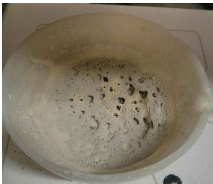
Figura 4.3 Aspecto final dos precursores da KBNNO quando não ocorre a reação de combustão ( \varphi=1 ).
