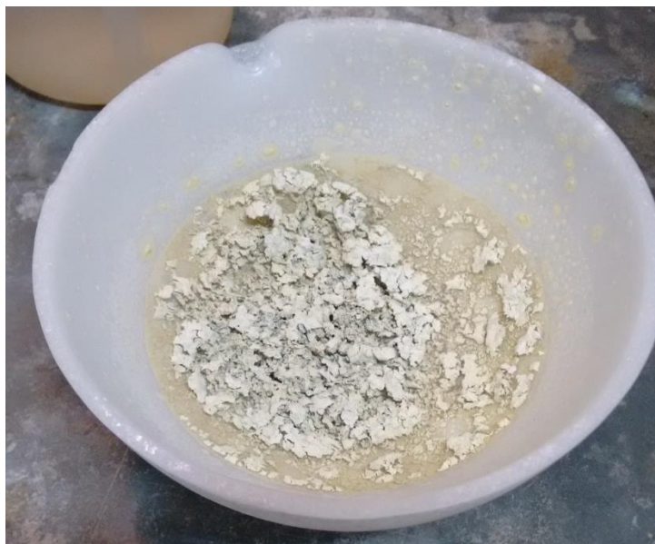
Figura 4.6 Aspecto do produto obtido após a combustão da KBNNO. São observados flocos de aglomerados fracos do pó de coloração esverdeada.
