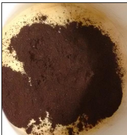
Figura 4.29 Aspecto do pó obtido na combustão dos precursores da KBFO após desaglomeração manual em almofariz.
