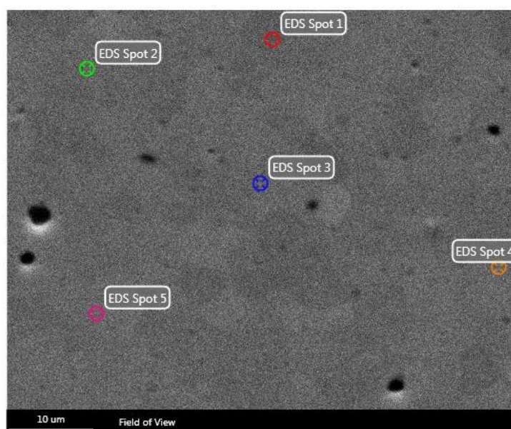
Figura 3.11 Exemplo de coleta de espectros de EDS no modo ponto para a amostra BCY14. No programa de controle EDAX TEAM™ os pontos ( spots ) a serem analisados são programados previamente e em seguida, é feita a coleta do espectro de EDS em cada um destes.
