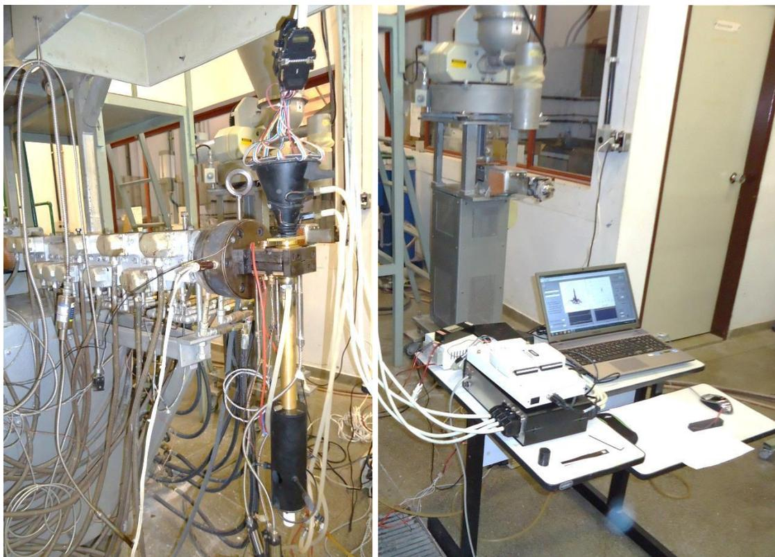
Figura 5.15 Detector de LALLS *in-line* montado no cabeçote da extrusora dupla rosca W&P ZSK-30 e as placas A/D e microcomputador para a coleta dos sinais.
