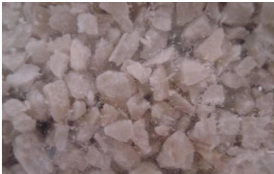
Figura 4.6 – Placas moídas para alimentação do funil de extrusão
