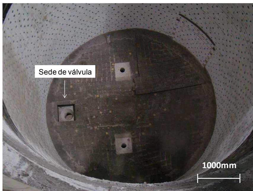
Figura 3.6.2 – Posicionamento da sede de válvula no fundo da panela antes da primeira corrida.
