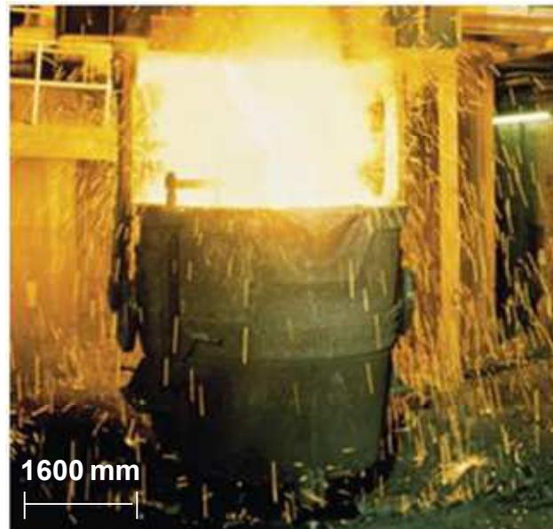
Figura 3.3.1 – Carregamento da panela de aço de 300 toneladas após o processo de transformação de gusa em aço no conversor LD.
