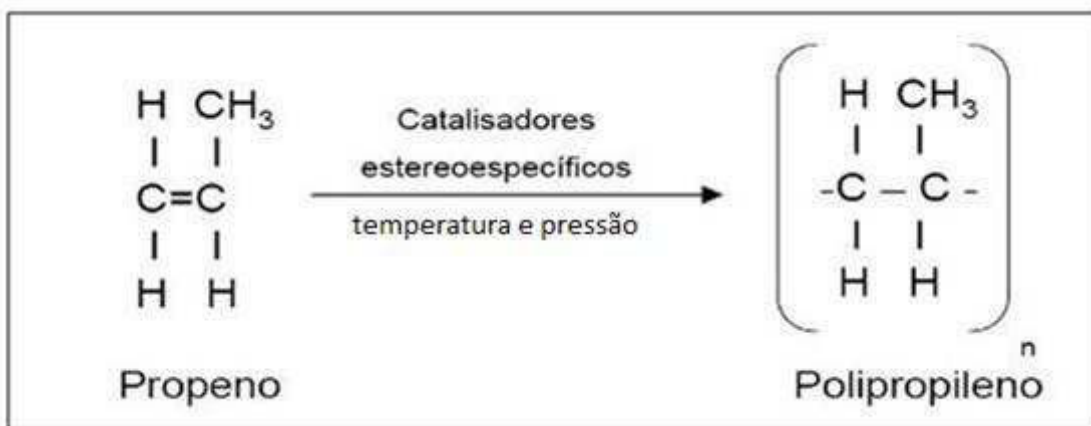
Figura 2.1: Esquema representativo da transformação do monômero em estrutura polimérica do PP.
