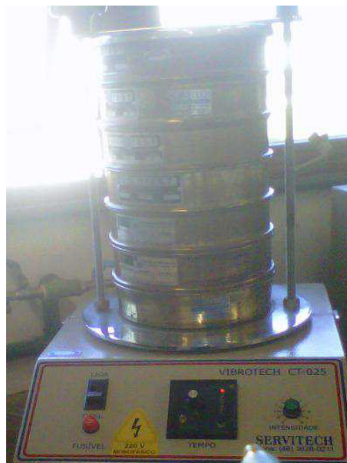
Figura 4.3: Peneira Vibratória utilizada para a classificação granulométrica
