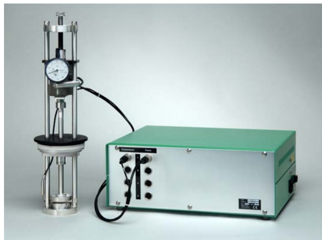
Figura 2.7 O aparato experimental comercial para ensaios de relaxação de tensões em tração, adaptado de Ronan et al. [17]
