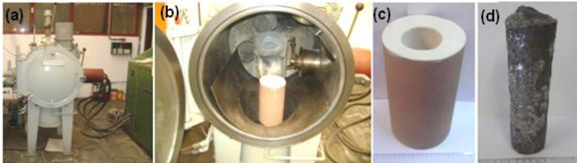
Figura 5.1: (a) e (b) Forno VIM do laboratório de fundição do Departamento de Engenharia de Materiais da UFSCar, (c) molde de areia utilizado para produção das ligas e (d) tarugo obtido .
