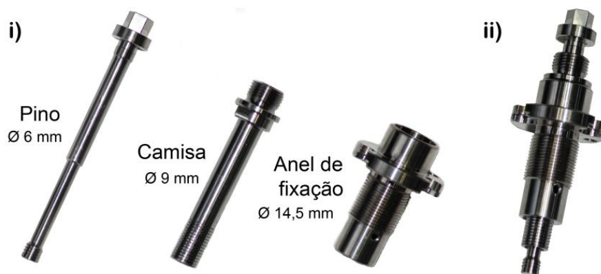
Figura 3-12 – i) Componentes da ferramenta de FSpW: o pino, a camisa e o anel de fixação. ii) Montagem da ferramenta: o pino é encaixado dentro da camisa, que são posicionados dentro do anel de fixação.
