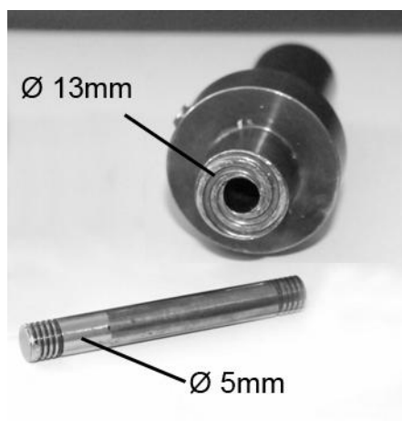
Figura 4-2 – Ferramenta selecionada para a soldagem das amostras de PMMA. O pino inserido no orifício do rebaixo tem um comprimento útil de 2,25 mm.
