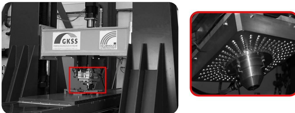
Figura 4.2 Sistema Gantry com gás inerte acoplado junto à ferramenta.
