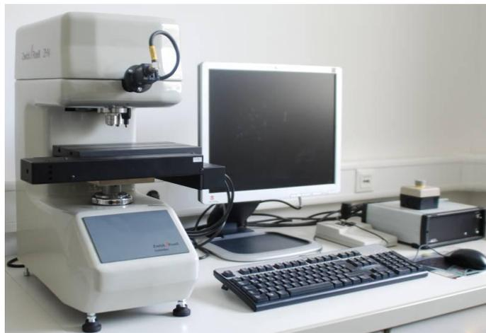
Figura 4.6 Equipamento Zwick/Roell ZHV utilizado no levantamento dos perfis de microdureza Vickers.
