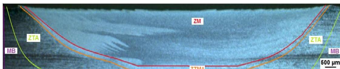
Figura 5.5 Diferentes zonas da solda identificadas na seção transversal das juntas (condição 3).
