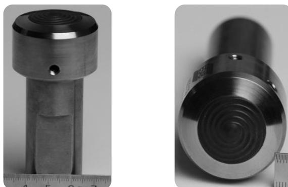
Figura 4.3 Ferramenta a base de PCBN utilizada no trabalho.
