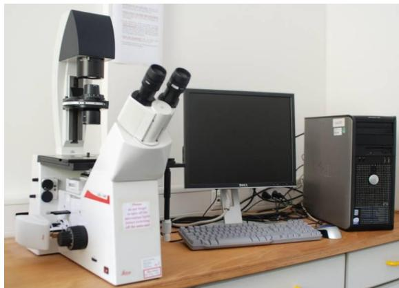
Figura 4.9 Microscópio ótico Leica DM IRM para análise metalográfica.
